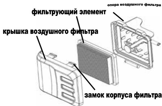
Грязный воздушный фильтр уменьшает поступление воздуха в карбюратор, изменяя соотношение воздушно-топливной смеси. Это приводит к образованию нагара и повреждению двигателя. Производить очистку или замену поролонового элемента воздушного фильтра необходимо каждые 10 часов работы. Состояние воздушного фильтра является одним из основных условий надежной работы двигателя.
